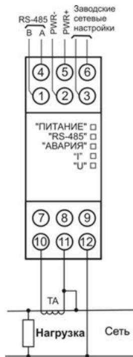
**Рисунок Б.3 – Подключение прибора к однофазной сети через согласующий трансформатор тока**
