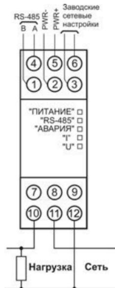
Рисунок Б.1 – Подключение прибора к однофазной сети
