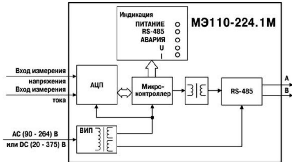
Рисунок 3.1 – Структурная схема прибора
